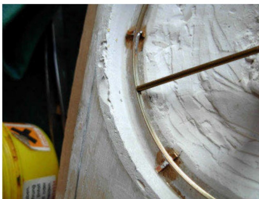
... die exakte Einhaltung vom Radius beim Auflöten des Gleisprofils.
