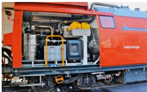
Innereien des Tanklöschwagens mit Pumpen usw.
