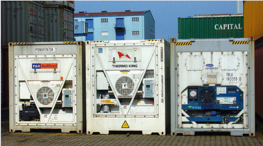
Bild 10 Während die zwei rechten Kühlaggregate von «Thermo King» sind, ist das des rechten Kühlcontainers vom Konkurrent «Carrier».
