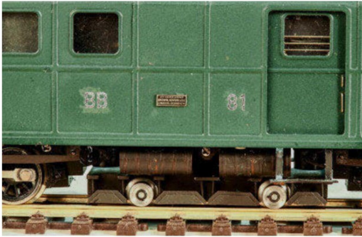
Details am Bremsgestell der elektromagnetischer Schienenbremse.
