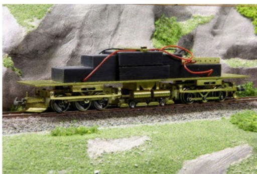
Bereits mit Getriebeabdeckungen erfolgen erste Fahrversuche auf der Anlage.
