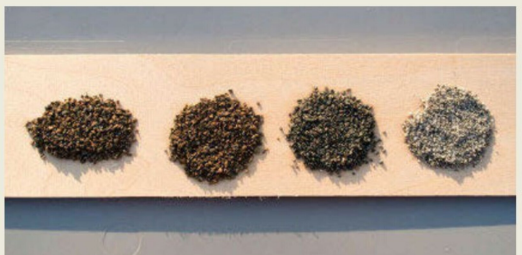
Sehr hilfreich ist vorgängiges, probeweises Mischen von Schotter.
