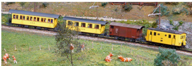
HGe 2/4, 400 PS; 36t, Last: 6 Achsen, 35t, 84 Plätze, V max 15 km/h
