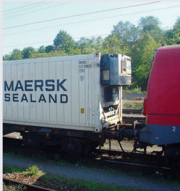
Bild 12 «Genset» von der Reederei «Carlisle» am Kühlcontainer von «MærskSealand».
