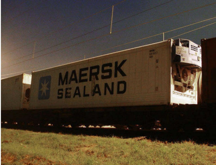
Bild 3 Bewusst überbelichtete Aufnahme des 40' «high cube reefer» von «MærskSealand» mit angehängtem und laufendem «genset».
