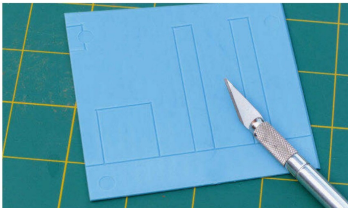
Die Rückseite der Pikestuff-Platten für die Wände sind mit angezeichneten Schneidelinien versehen, um allfällige Fenster und Türen auszuschneiden.
