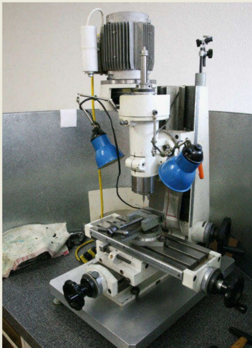
Kernstück in der Modellbauwerkstatt ist die selbstgebaute Fräsmaschine.
