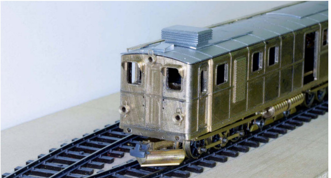
Aufnahmen aus der frühen Bauphase lassen gut Christian Albissers Bauart mit gefrästen Wänden erkennen.
