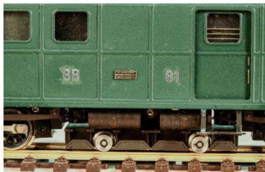
Details am Bremsgestell der elektromagnetischer Schienenbremse.
