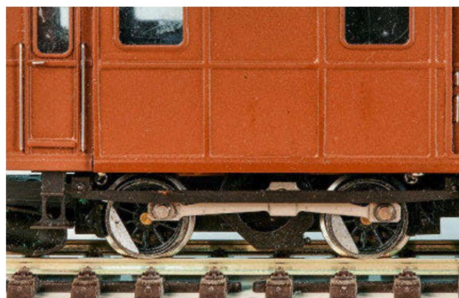
Details am Bremsgestell der elektromagnetischer Schienenbremse.
