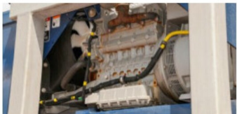
Bild 14 Ein Dieselmotor treibt den Stromgenerator an. Der Lüfterpropeller am anderen Ende sorgt in Zusammenarbeit mit einem Wasserkühler für die nötige Kühlung des Motors.
