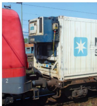
Bild 11 Laufendes «genset» am «Mærsk-Container» im Bahnhof von Weil am Rhein.
