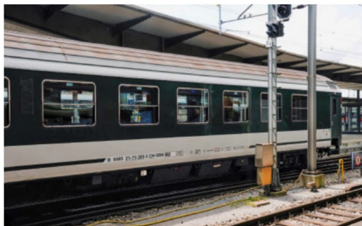
Wagen B 5085 31-73 393-3 CH-SBB mit fehlendem RIC-Eintrag.
