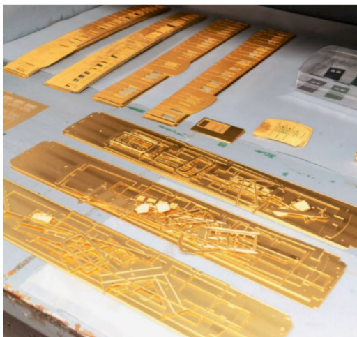
Geätzte Bleche für italienische Centoporte-Personenwagen.
