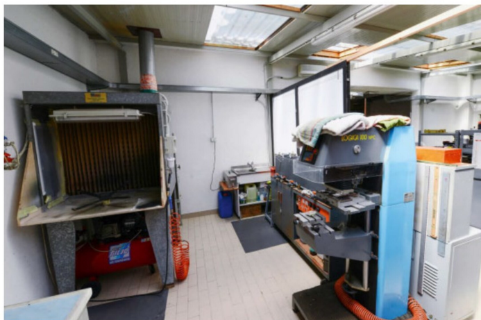
Hier wird spritzlackiert und mit Tampondruck Beschriftungen aufgebracht.
