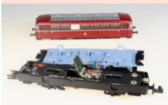
... dem eingelötetem Funktionsdecoder.
