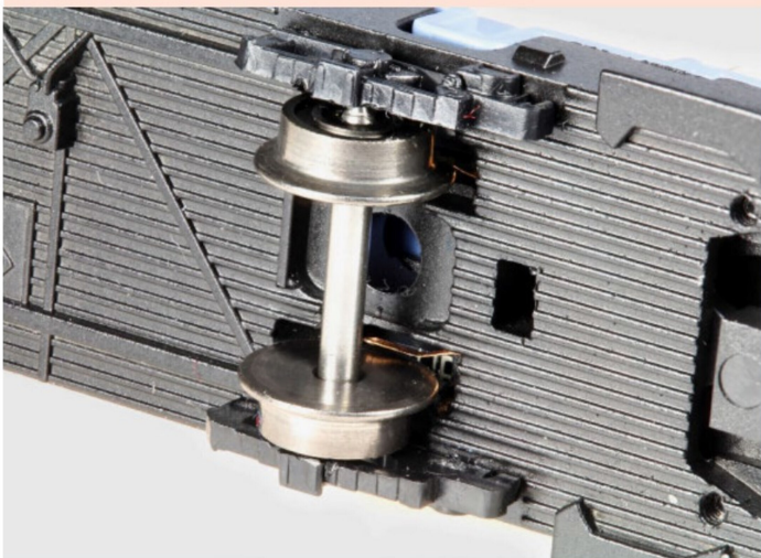
Die feinen Radschleifer des Steuerwagens ...
