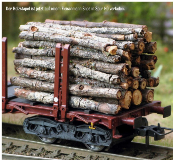
Diese Holzladung benötigt weniger Äste mit dem Polystyren-Kern. Diese Methode geht jedoch nur auf Wagen mit hohen Stirnborden.
