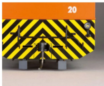
Die Kadee-Kupplung befindet sich auf Originalhöhe.
