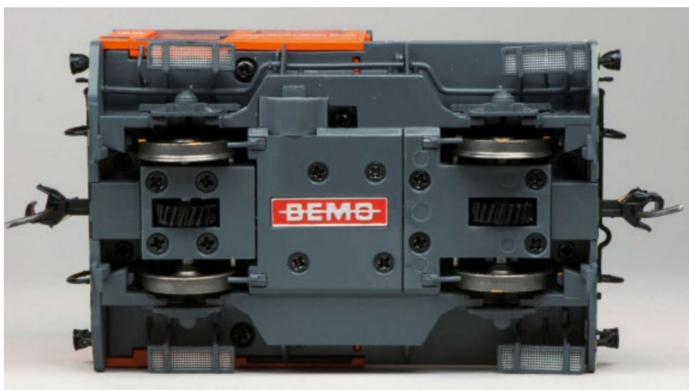
Der Blick von unten auf die diversen Gehäuseschrauben sowie die Radstromabnehmer.
