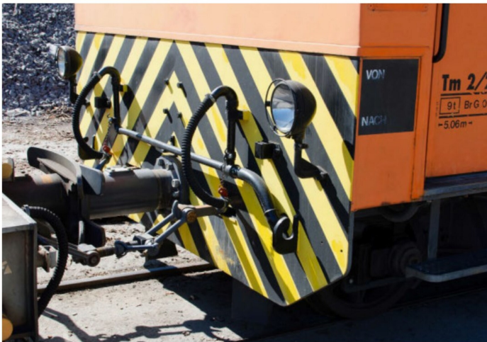
Detail der Pufferbohle mit Mittelpuffer, Kupplungen, Bremsschläuchen und Fahrzeuglampen.
