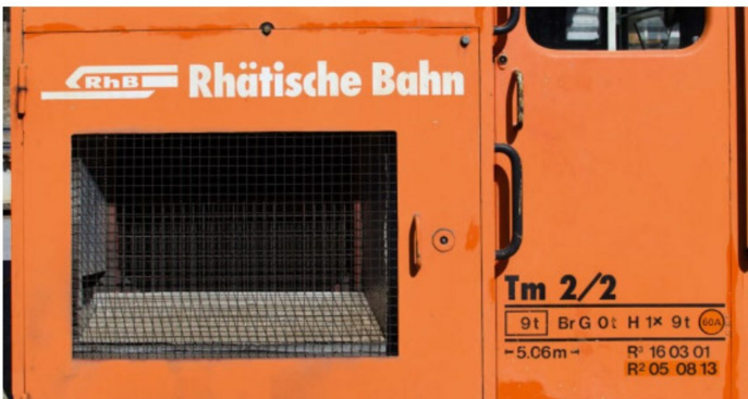
In der linken Fahrzeugsseite wird durch ein Gitter hindurch die Zuluft für den Dieselmotor zugeführt.
