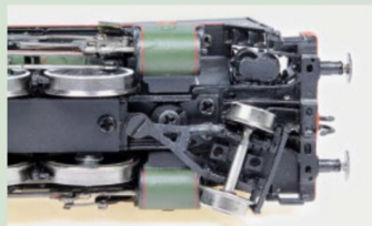
Die Vorlaufachse ist eingeklippt.
