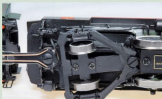
Die Nachlaufachse ist verschraubt.
