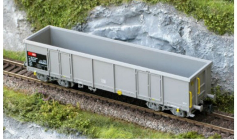
Ein Hochbordwagen Eaos der SBB als Modell von Liliput direkt aus der Verpackung. Mit Verwitterung und Ladung wird der Wagen realistischer wirken, man vergleiche ihn mit dem Bild ganz unten.
