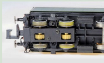
Haftreifen sorgen für Vortrieb.
