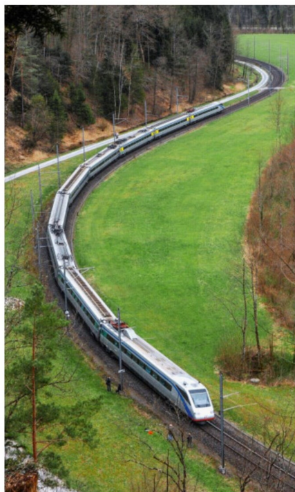
In der Vogelschauperspektive zwischen Sihlwald und Langnau-Gattikon kommt die aktive Neigeeinrichtung des FS ETR 470 001 gut zur Geltung.
