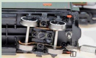
Vier Schrauben halten das Gehäuse.
