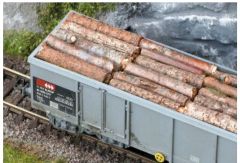
Der Liliput Eaos nach einer leichten Verwitterung und dem Einbringen einer «blinden» Ladung unten aus 6 mm dicker Platte. Die «echte» Ladung besteht aus zwei Lagen richtigen Holzes aus dem Garten.
