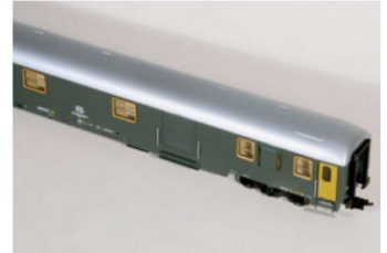
Bild 30 Rolladentüre und Beobachtungsfenster am Bagagliaio Tipo UIC-X.
