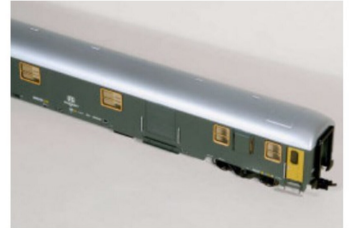
Bild 30 Rolladentüre und Beobachtungsfenster am Bagagliaio Tipo UIC-X.
