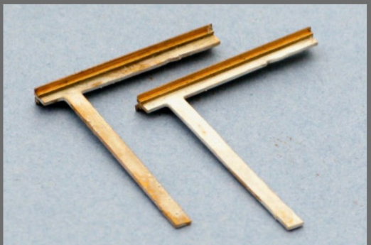
Die Dachträger bestehen aus dem Messingteil mit einem zusätzlichen L-Profil. Sie werden mit Superkleber zusammengebaut, ebenso die angesetzten Teile.
