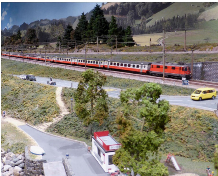
Swiss-Express 1975: Re 4/4 II , 4,7 MW, 80t, Last: 36 Achsen, 283t, 505 Plätze, Vmax. 140 km/h.
