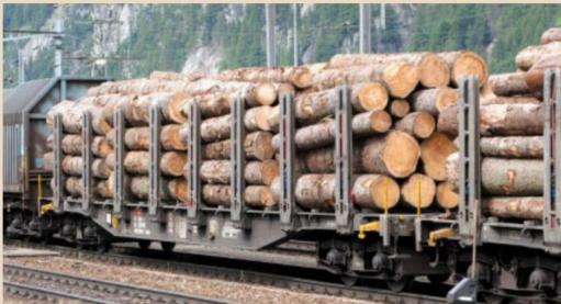
Ebenso im Mai 2009 war ein südwärts fahrender Zug mit einem Sps-Wagen mit einer Holzladung unterwegs. Die roten Spanngurten halten die Stämme in ihrer Position.
