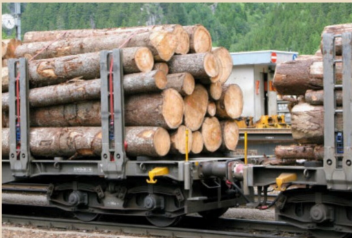
Detailansicht des Sps-Wagens und den bei diesen Wagen in den Rungen integrierten Spanngurten.
