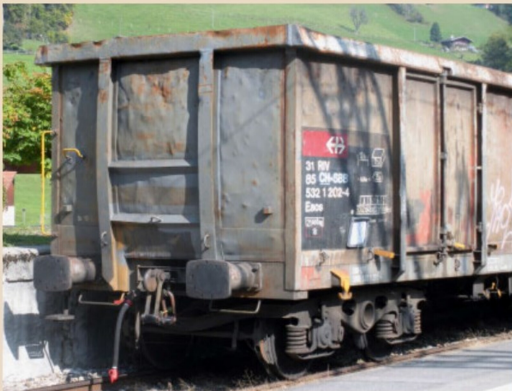
Offene Güterwagen für den Holztransport, wie dieser Eaos, sind an den Aussenwänden meist stark mitgenommen vom Be- und Entladen des Ladegutes. Diese Beulen in den Seiten- und Stirnwänden sind im Modell recht heikel nachzubilden mittels Verformung des Kunststoffes mit Wärmen und Drücken der Stellen, die man etwas verformt haben möchte.
