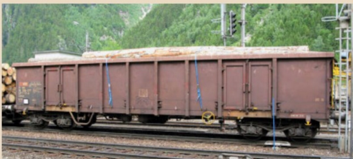
Sicherungsbänder zum Festhalten der Stämme in diesem Eanos der SBB, gesehen in Göschenen im Mai 2009. Diese Bänder habe ich in verschiedenen Farben gesehen, so auch schwarz, blau, grau, rot und gelb.
