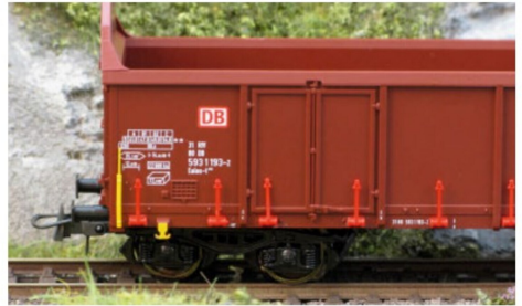
Der Ealos von Roco nach dem Anbringen von verschiedenen Zurüstteilen, die jetzt die Sicherungseinrichtungen der Hölzer darstellen. Diese Einsteckteile werden mit Vorteil mit einer Pinzette behandelt.
