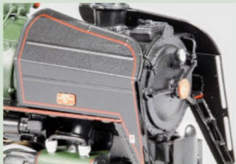
... sorgen fürs typische Bild: Die Windleitbleche.
