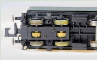
Haftreifen sorgen für Vortrieb.
