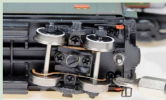
Vier Schrauben halten das Gehäuse.
