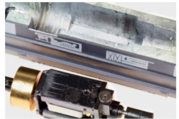
Ein fünfpoliger Motor treibt die Lok an.
