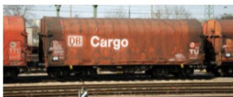
Längst überholt ist diese Anschrift: Nach DB Cargo folgte DB Railion, heute heisst das Unternehmen DB Schenker Rail AG. Gesehen an einem Richtung Schweiz rollenden Shimmms-tu178 zum Transport von Coils.
