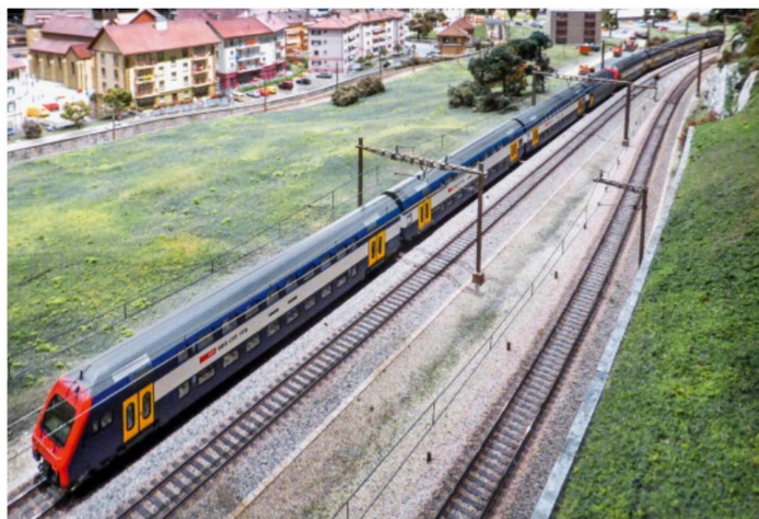
2 Re 450, 6,4 MW, 148 Tonnen, Last: 24 Achsen, 352 Tonnen, 782 Plätze, V/max. 130 km/h.
