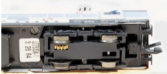
Drehgestell II, nur eine Achse ist angetrieben!
