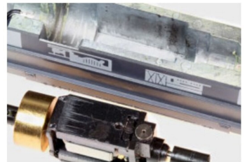
Ein fünfpoliger Motor treibt die Lok an.
