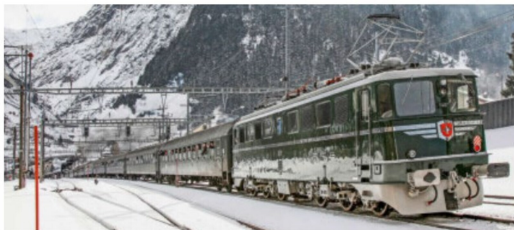
Am Zugschluss lief die Ae 6/6 11407 Aargau mit, um wo nötig nachzuschieben, damit am Berg die Geschwindigkeit von 50 km/h eingehalten werden konnte. Durch den Scheiteltunnel ist eine Elektrolok Vorschrift, Göschenen, 5. März 2015.
