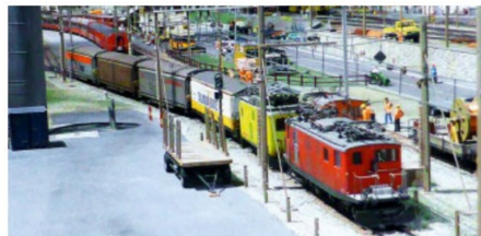
HGe 4/4', 890 kW, 47 t. 18 Achsen, 107 t, 55 km/h.
