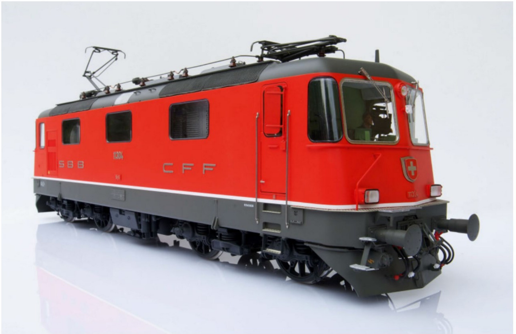
Die rechte Seite der Unfall-Re 4/4 II mit den unterschiedlichen zwei Fronten. Eine Folge davon ist hier mit dem Rückspiegel in der Führerstandstüre sichtbar.
