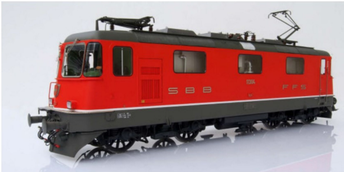
Die gegenüberliegende Seite der 11304 mit dem kleineren, eingesetzten Rückspiegel hinten.
