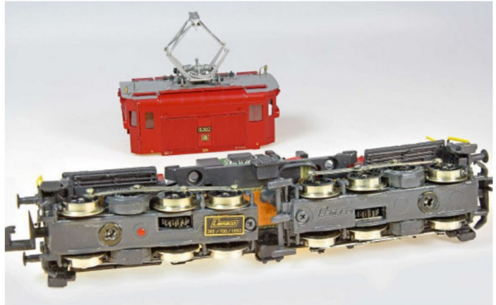
Nach der Montage müssen sich die Laufgestelle gegenüber Haupttrahmen leicht bewegen lassen.
