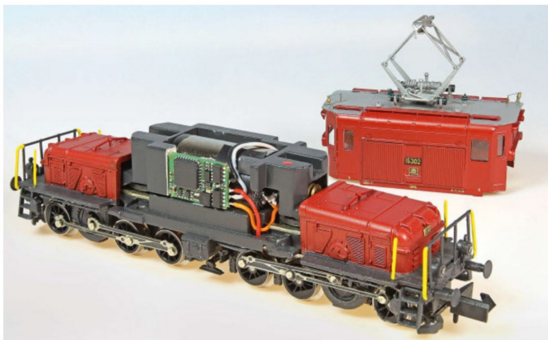
Die Wiedermontage der Vorbaugehäuse erfordert etwas Sorgfalt, es darf nichts einklemmen.
