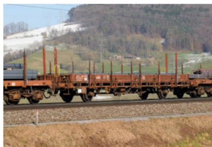
Einen Kontrast stellte der «althergebrachte» Ks, ebenso von CFL-Cargo, im gleichen Zug her; die bis zu 120 km/h einsetzbaren Wagen können mit bis zu 62 Tonnen beladen werden.
