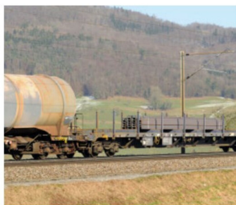
Stahltransport am Bözberg: Ganze 25 Meter ist der Rbnps Wagen von CFL-Cargo (L-CFLCA) lang. Die bis zu 120 km/h einsetzbaren Wagen können mit bis zu 62 Tonnen beladen werden.
