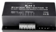
Der «System Detector 7» verträgt Ströme von bis zu 7 A.
