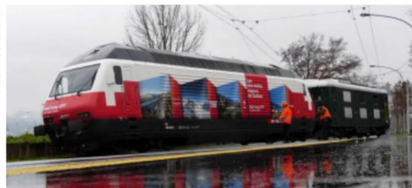
Das unübliche Gespann mit Bm 4/4 18451 und Re 460 048 beim Überqueren der dafür abgesperrten Haldenstrasse. Die Räder der zugewandten Seite rollen auf den Spurkränzen über die breite, mit einer Kerbe versehene Aufлаufschiene.
