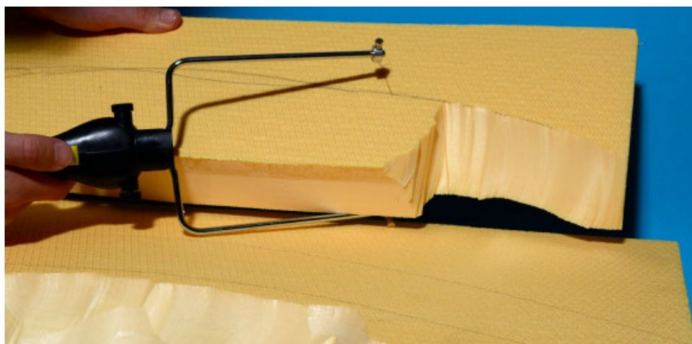
Unterbau aus geschichteten Styrodurplatten, welche sich bequem mit dem Heissdraht schneiden lassen.
