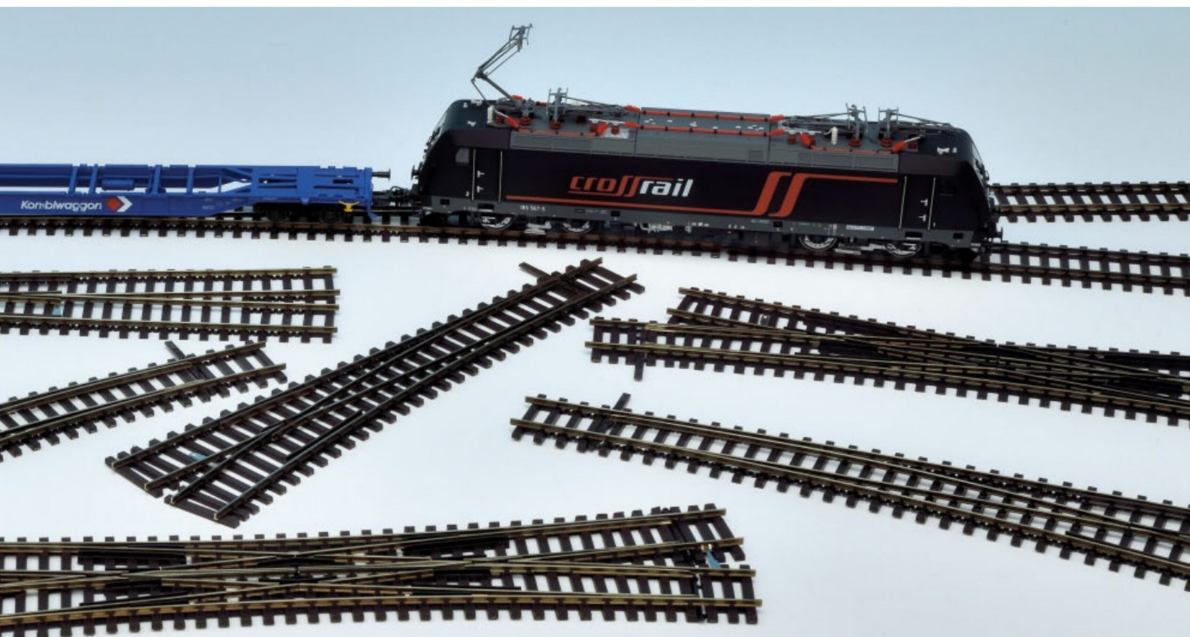
Die Doppelkreuzungsweiche mit aussenliegenden Zungen hat eine Länge von 276 mm, ihr Bogenradius beträgt 1050 mm. Den Versatz beim Befahren mit massstäblichen Wagen kann man als minimal bezeichnen.
