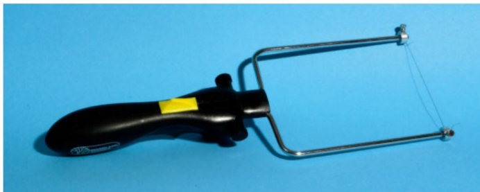
Nochmals der «Hot Wire Foam Cutter» von Woodland Scenics zum Schneiden von Styrodur im Detail.
