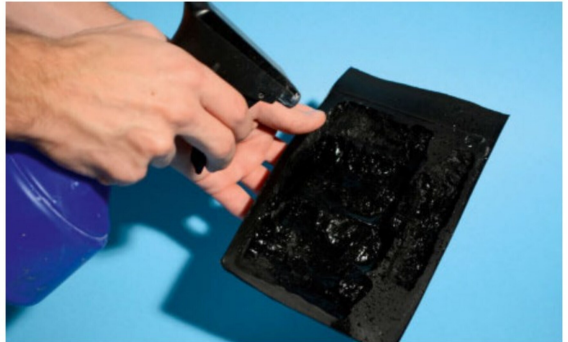
Die Form wird mit Wasser angefeuchtet damit sich beim Gießen keine Bläschen bilden.
