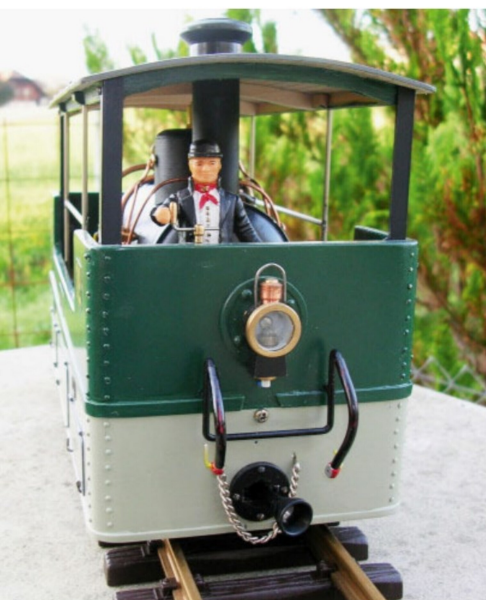
Markante Stirnfront mit Kupplung, Lampe und Bremsschläuchen.
