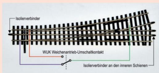
Darauf ist bei der Herzstückpolarisierung zu achten: Bei Dreischieneweichen mit Abzweig in H0 sind vier Isolierverbinder anzubringen.
