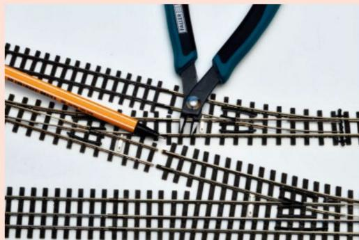
Werden H0e-Schmalspurweichen von Gerade auf Abzweig verbunden, so sind einige Schwellen passend zu kürzen.
