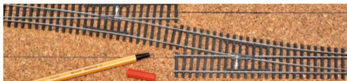
Der Normabstand beim Tillig-Elite-Gleis beträgt 59 mm. Die NEM empfiehlt im Bahnhofsbereich einen Gleisabstand von 52 mm. Um dies zu erreichen, müssen die abzweigenden Äste beschnitten werden. Ein positiver Nebeneffekt: Die Gesamtlänge reduziert sich.
