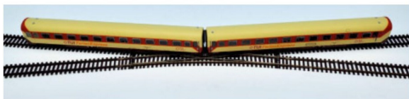
Die Doppelkreuzungsweiche mit aussenliegenden Zungen hat eine Länge von 276 mm, ihr Bogenradius beträgt 1050 mm. Den Versatz beim Befahren mit massstäblichen Wagen kann man als minimal bezeichnen.
