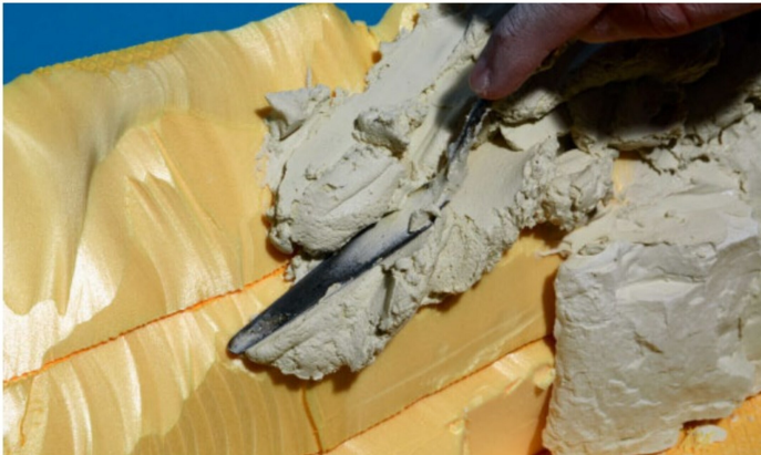
Eine etwa 2.5 cm dicke Gipsschicht wird aufgetragen und dabei bereits grobe Konturen modelliert.
