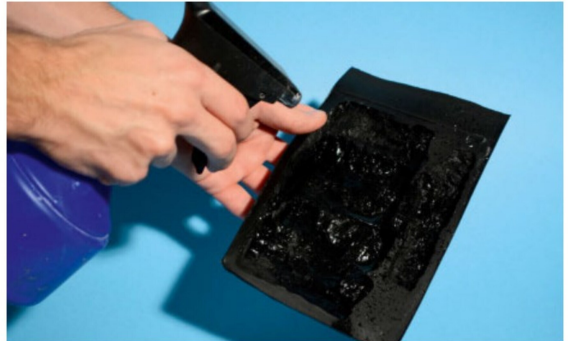
Die Form wird mit Wasser angeetzt damit sich beim Giessen keine Bläschen bilden.
