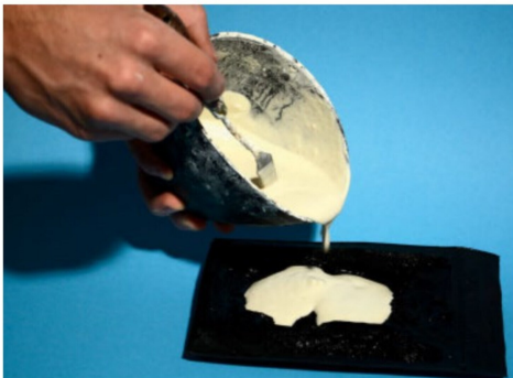
Das Ausgießen der Formen mit flüssigem Gips.
