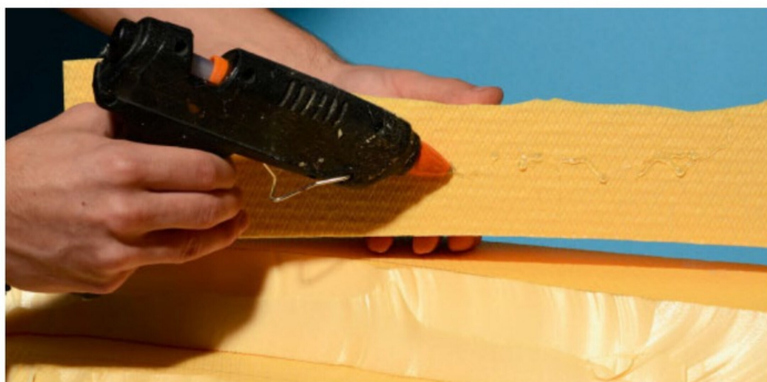
Die einzelnen Schichten werden anschliessend verklebt. Die Heissleim-Pistole leistet dabei gute Dienste.
